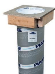
Pour maintenir le coffrage et régler sa verticalité, le carcan de tête possède d'une part des pattes métalliques bloquant la tête de la colonne et d'autre part des blocs en bois permettant d'y fixer des étais ou des voliges (suivant 2 axes perpendiculaires).
